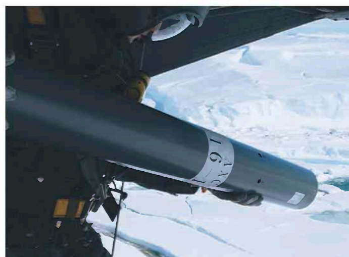
東南極で水温や塩分を測る観測装置を投下した＝第61次南極地域観測隊提供
